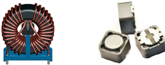
Figura 10 – Esquerda: indutor toroidal enrolado em torno de um material ferromagnético. Empregado em aplicações de maior potência/corrente. Direita: indutor com núcleo ferromagnético blindado e em encapsulamento SMD. Usado para pequenos sinais.
