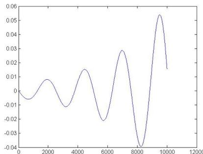
Figura 3.4 – Comportamento do sistema de amortecimento para  $M = 800\text{kg}$ ,  $b=40\text{N-s/m}$  e  $k=50\text{N/m}$  considerando um impacto de  $1\text{N}$  no formado de uma função impulsiva. Eixo horizontal representando tempo (dado em segundos) e vertical representando o deslocamento (em metros).
