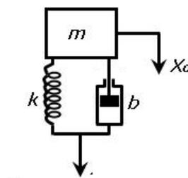
Figura 3.3 – Modelo mecânico para amortecimento de um veículo.
